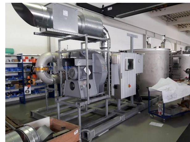
September 2018: Zusammenbau der Einzelkomponenten der Regenerativen Thermischen Oxydationsanlage (RTO) bei der Firma BMF Haase Energietechnik
