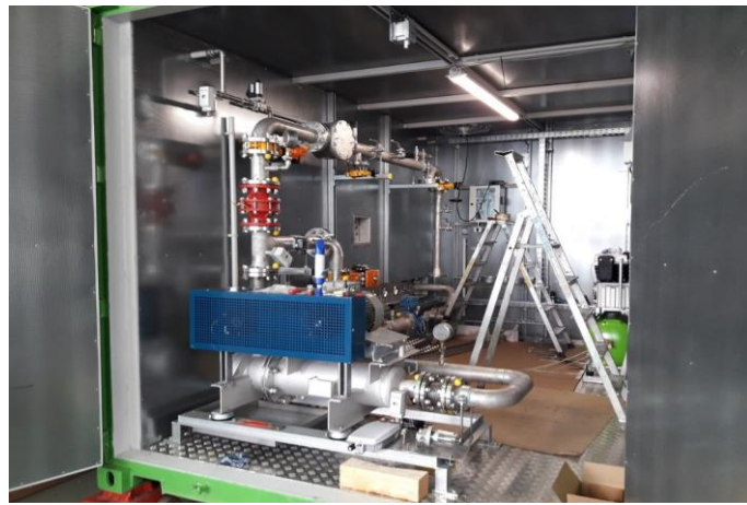
September 2018: Zusammenbau der Einzelkomponenten der Regenerativen Thermischen Oxydationsanlage (RTO) bei der Firma BMF Haase Energietechnik
