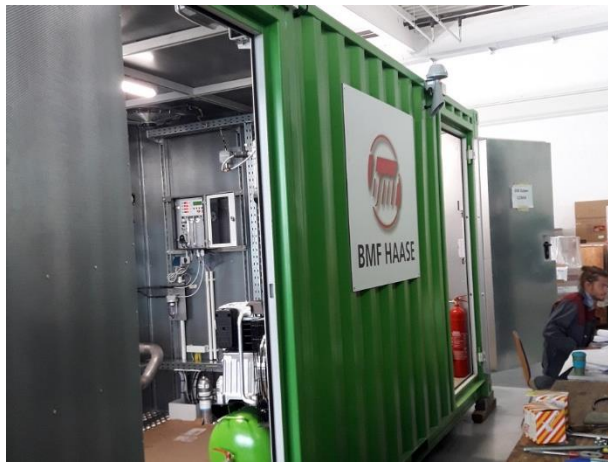
September 2018: Zusammenbau der Einzelkomponenten der Regenerativen Thermischen Oxydationsanlage (RTO) bei der Firma BMF Haase Energietechnik
