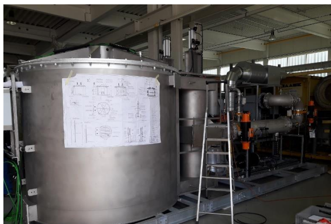
September 2018: Zusammenbau der Einzelkomponenten der Regenerativen Thermischen Oxydationsanlage (RTO) bei der Firma BMF Haase Energietechnik
